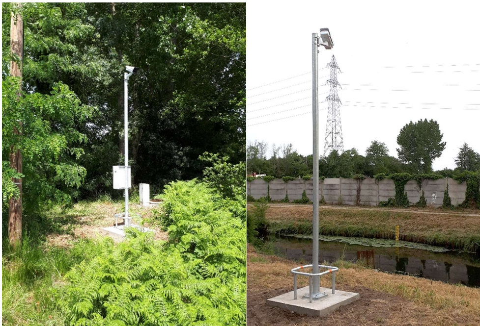
Débitmètre par système caméra sur le bras nord et le bras sud de la Jalle
