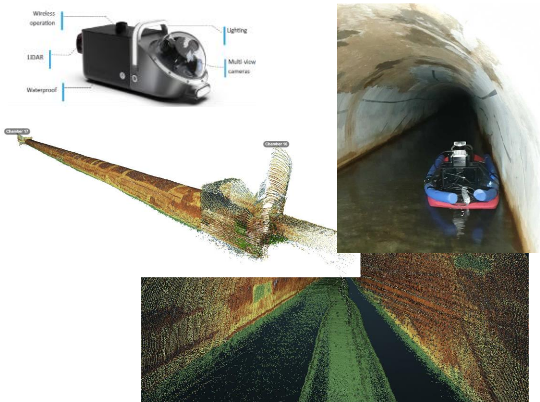
Illustrations du test du multicapteurs Telesto de Headlight et des résultats de scan obtenus
