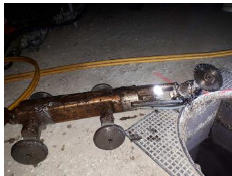
Robot fraiseur équipé d'un disque de découpe
