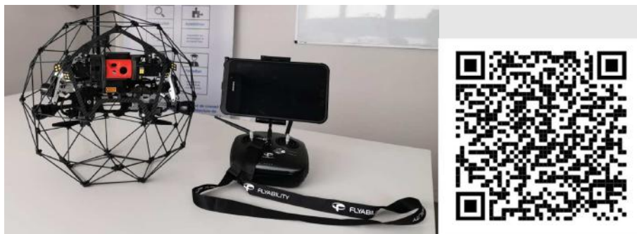
PHOTO 3 - EXPL.4.1 Drone volant - QRcode pour film sur les drones dans les réseaux assainissement
