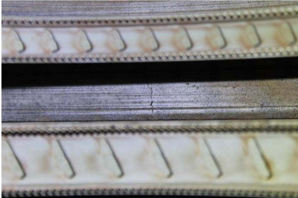
Photo 23 – Fissure du chemin des aubes du carter du compresseur
