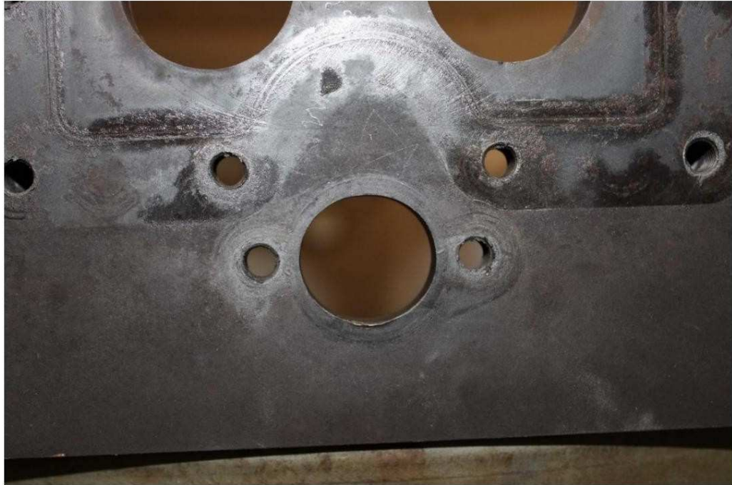
Photo 3 – Orifice usé du support de la chemise extérieure du carter de combustion
