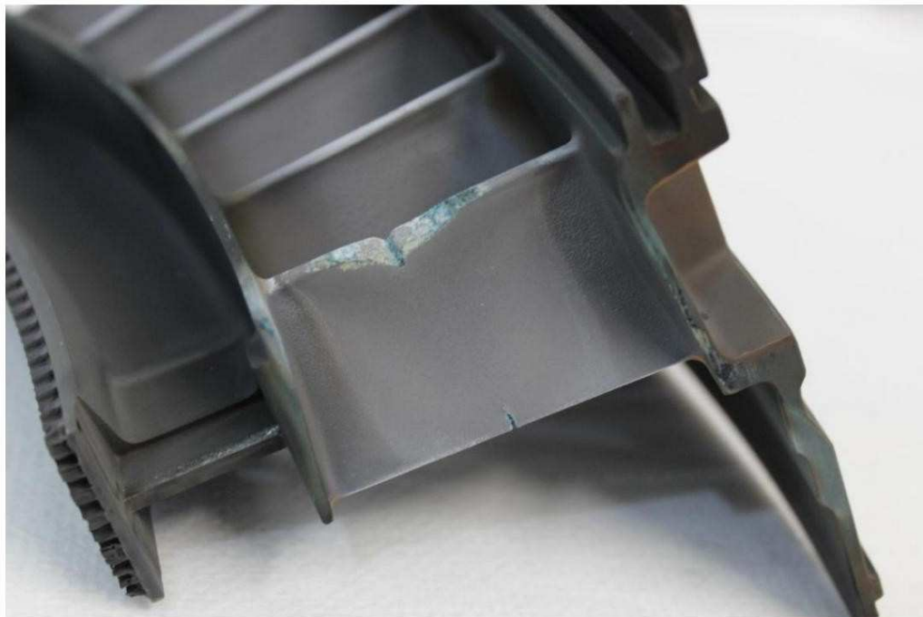
Photo 15 – Érosion des aubes de turbine étape 2
