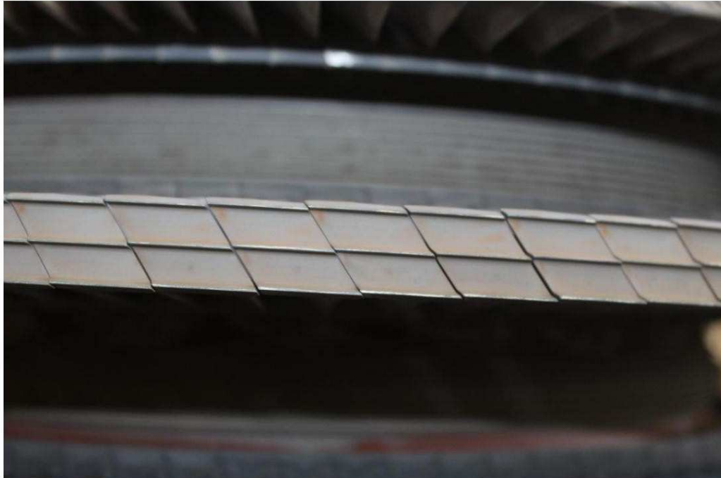
Photo 17 – État des aubes de turbine de l'étape 2
