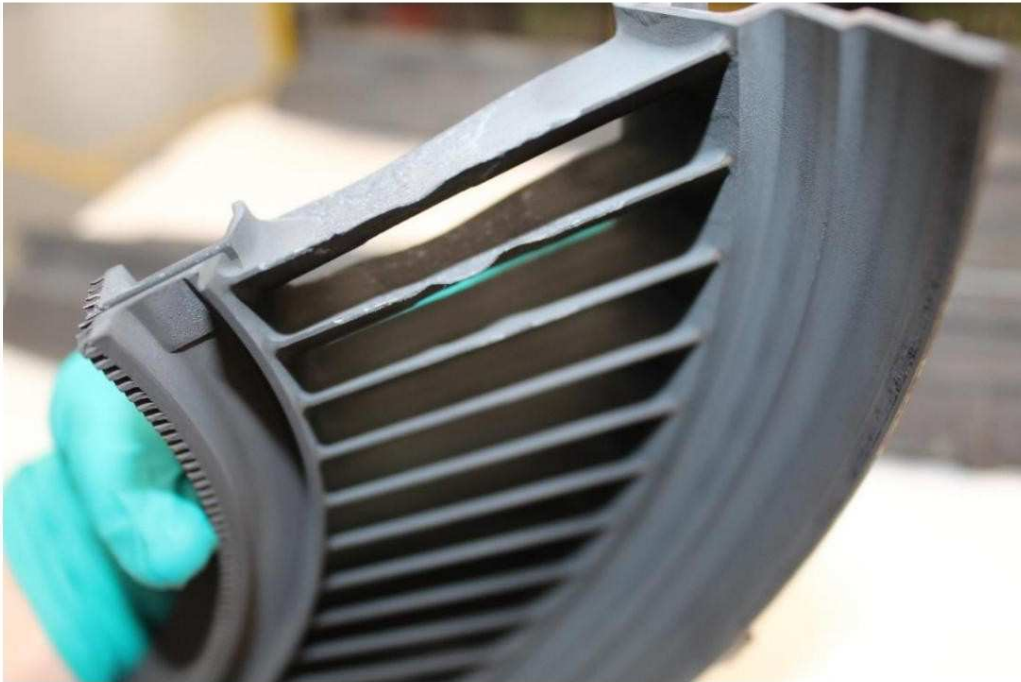
Photo 19 – Déformation du bord de fuite des aubes de turbine de l'étape 3
