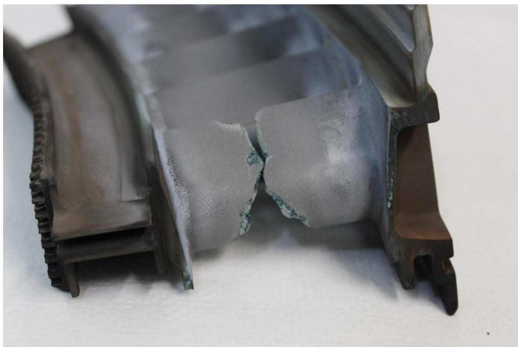
Photo 16 – Ailette brûlée à travers l'étape 2
