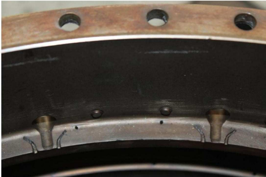
Photo 12 - Carter d'entrée de turbine rainuré
