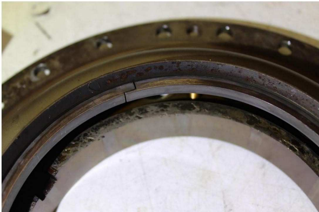
Photo 11 – Freting de la face de contact du support de roulement avant
