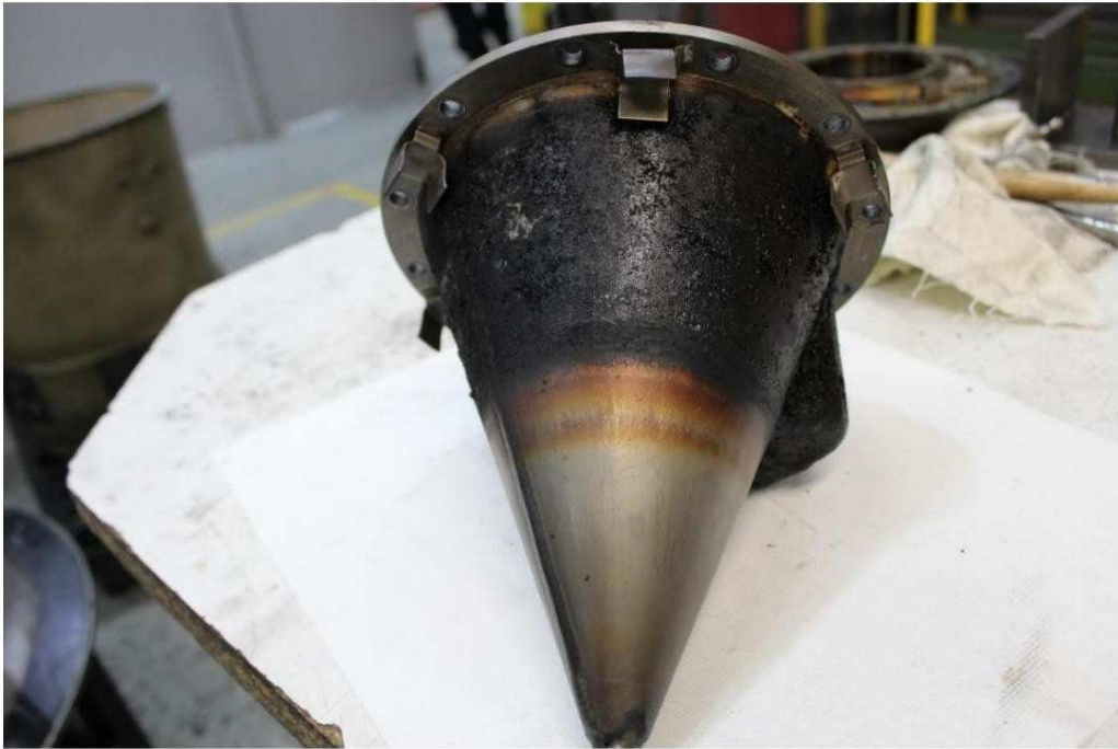
Photo 2 - Carter de pompe de récupération à revêtement de carbone
