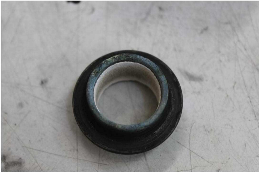
Photo 5 – Érosion du tube de croisement
