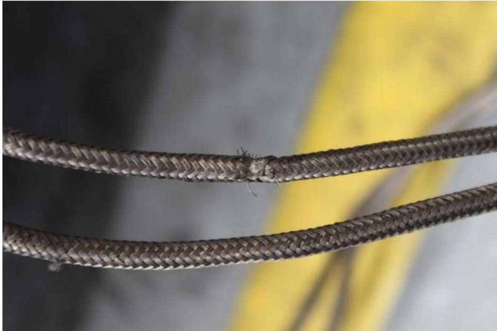
Photo 22 – Tresse de harnais TOT endommagée
