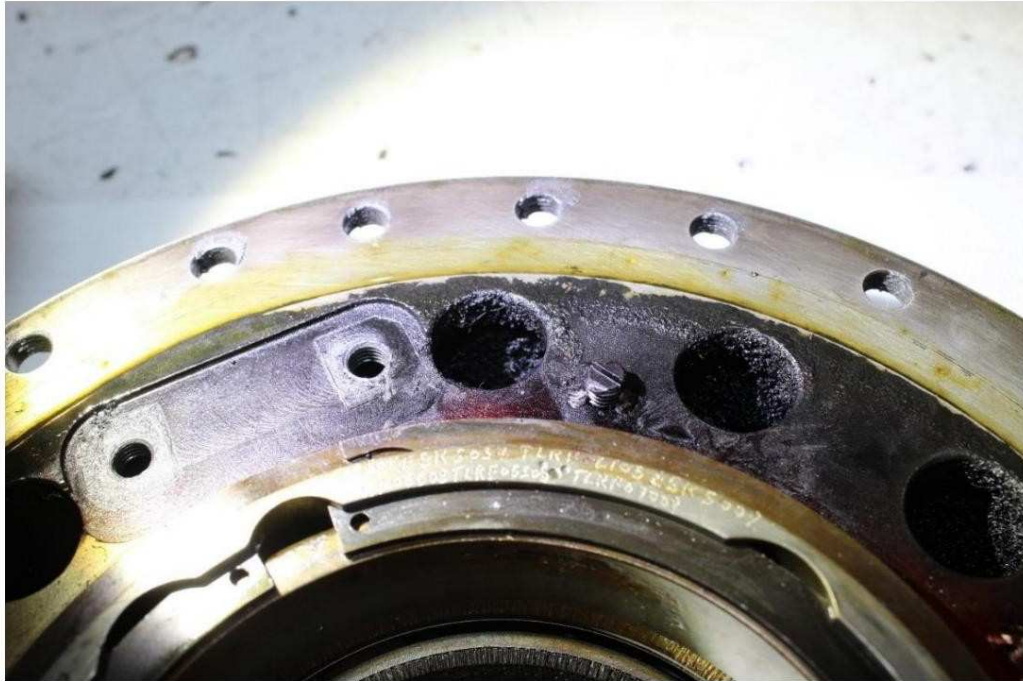
Photo 10 - Carbone dans le puisard du support de roulement avant
