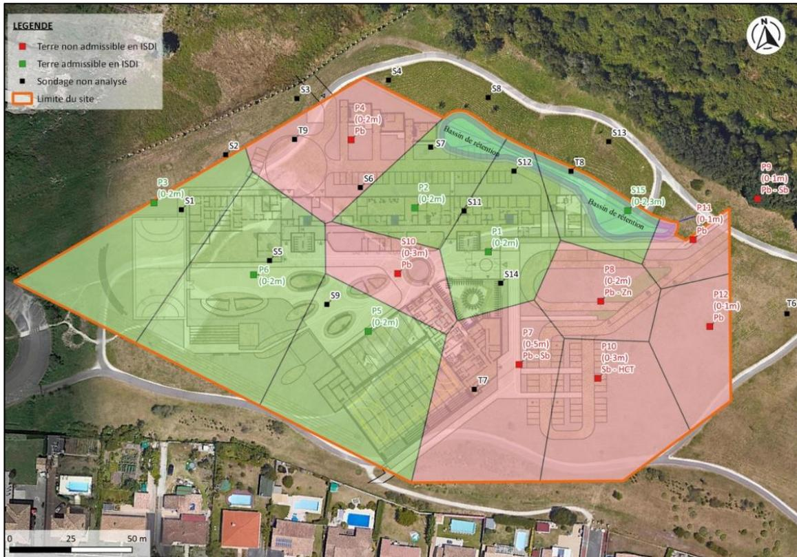
Figure 8 : Cartographie des filières inertes et non-inertes du site
