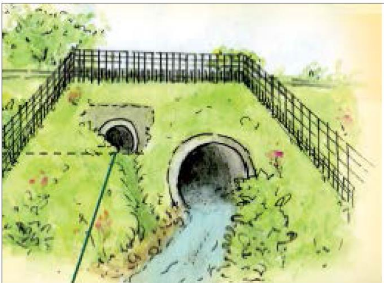
Figure 21 : Schéma de principe des passages à loutre à aménager, de type «buse sèche» avec grillage en entonnoir (Source : GMB 2010)
