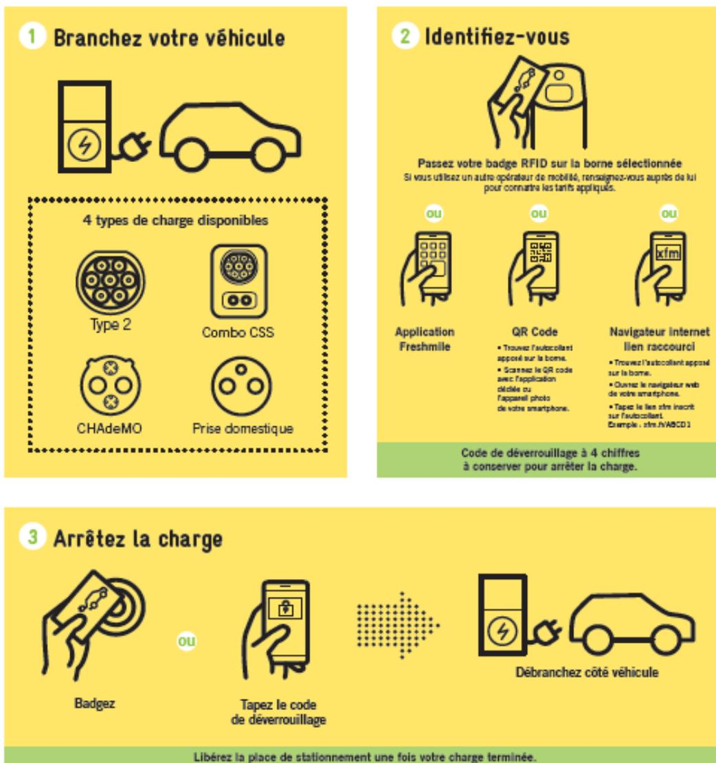
Figure 7- Procédure de déclenchement de la recharge sur une station rapide de la Métropole
