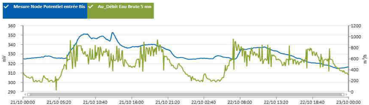
GRAPHIQUE 10 - SOC.1.1.3 Signal du biocapteur EB à l'aval des tamis et du débit EB sur 1 journée
