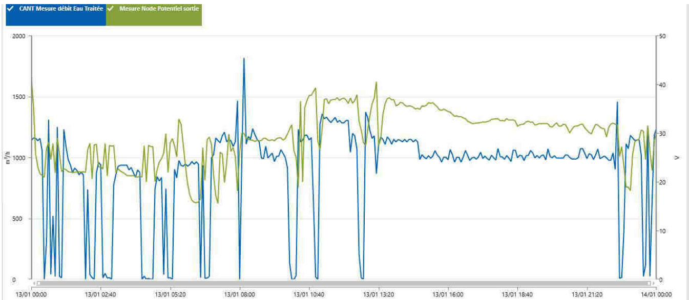
GRAPHIQUE 5 - SOC.1.1.3 Signal électrique du biocapteur (vert) et mesure de débit ET (bleu)
