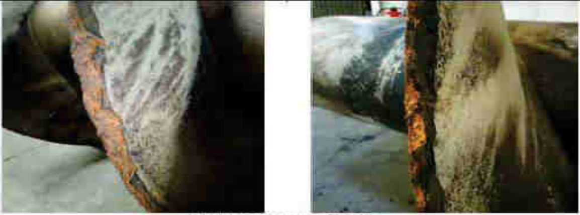
Oxydation importante des spires
