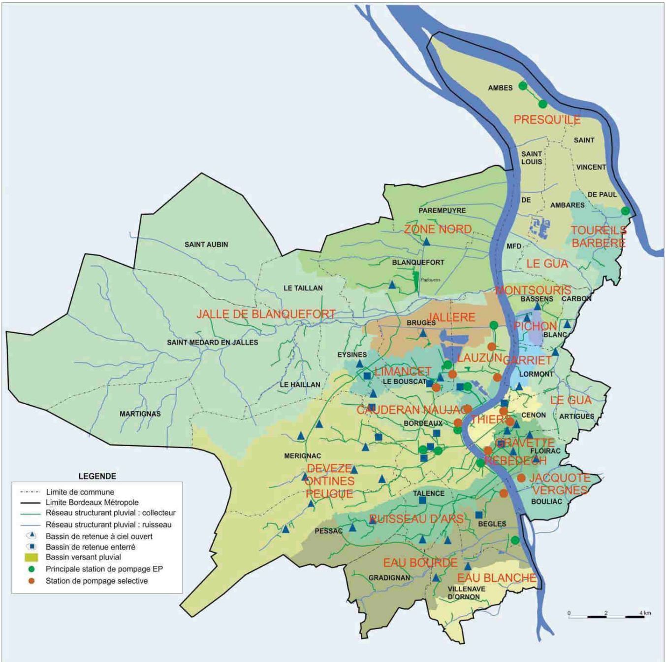
CARTE 1 – PAT.1.1. PRINCIPAUX OUVRAGES DE LUTTE CONTRE LES INONDATIONS PAR BASSIN VERSANT EN 2021
