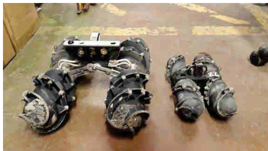
PHOTO 1 - EXPL.4.1 Drones rampants PREDIRE (à gauche, le modèle adapté aux collecteurs Ø300-400 mm, et à droite, celui pour les Ø200-250 mm)
