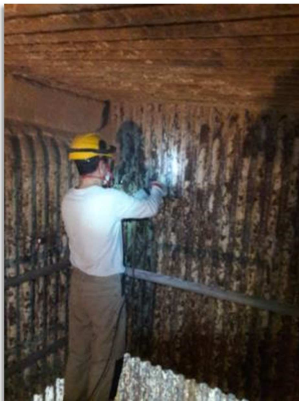
Figure 19 : Opérations de mesure d’épaisseurs lors de l’arrêt technique
