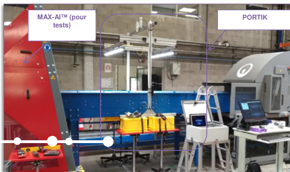
Figure 26 : Système Portik en fonctionnement positionné derrière un robot de sur-tri Max AI
