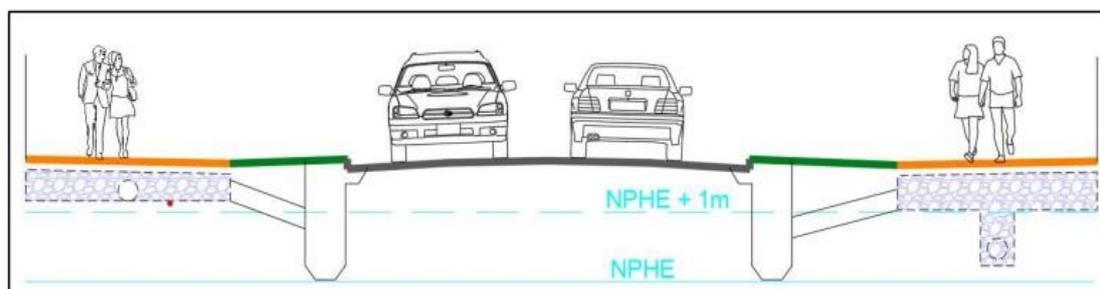
Figure 15 : Structure réservoir - Profil en travers
