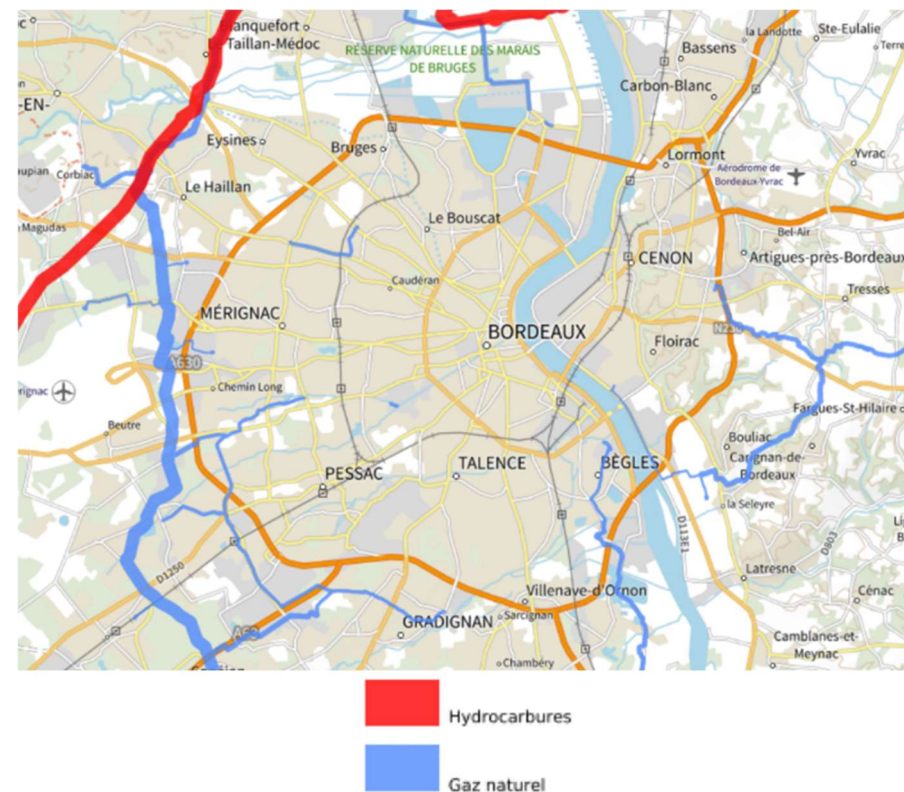
Figure 97. Les canalisations d'hydrocarbures et de gaz au niveau des corridors (source : Géorisques)
